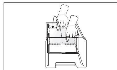
Полки и дверные отделения легко снимаются, их можно менять местами. Некоторые полки следует сначала приподнять с задней части, для того чтобы их можно было вытянуть на себя.
